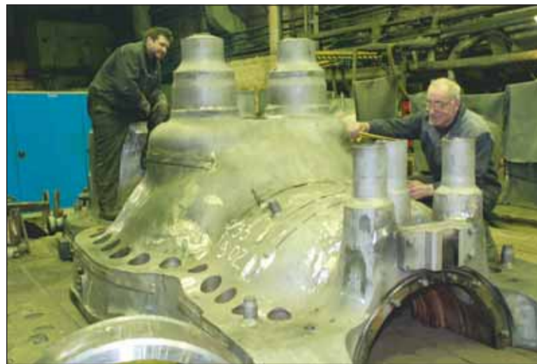
В 33-м цехе ЛМЗ изготавливается ЦВД рязанской турбины. Фото Владимира ТИМОФЕЕВА
